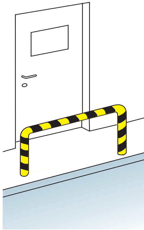
Figure 13. Chicane de protection devant une porte pour piétons.
