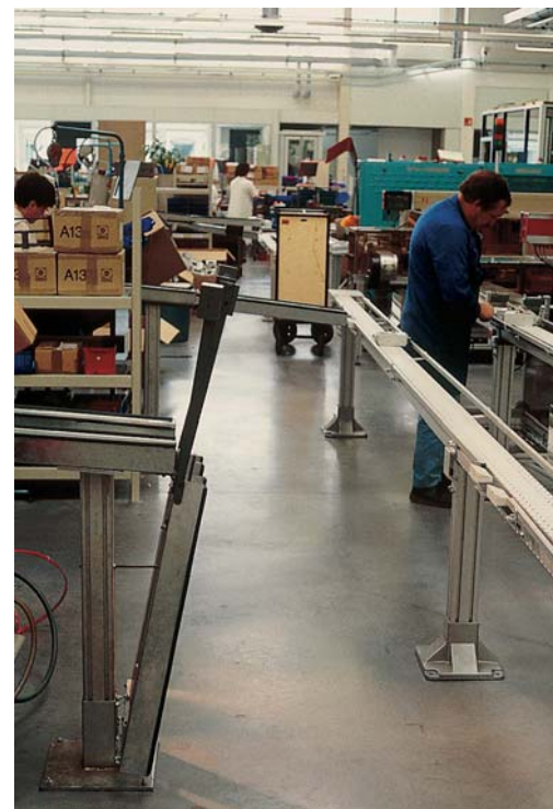
Figure 37. Passage protégé par interruption de la ligne du convoyeur.
